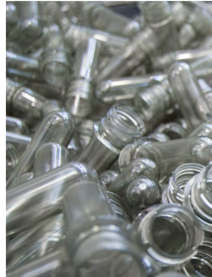
Preforms (Rohlinge) für Getränkeflaschen aus PET-Rezyklat, Bild: erema.com
